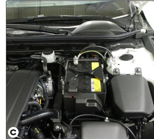
7. Débrancher le câble de la borne négative (-) de la batterie du véhicule. Si ce n'est déjà fait, enlever le fusible du porte-fusible jaune (fourni). Après avoir coupé le fil du porte-fusible, attacher la cosse à anneau et la fixer au câble de la borne positive (+) de la batterie du véhicule. À l'aide du raccord jaune (fourni), attacher l'autre extrémité du porte-fusible au fil **noir** de calibre 12. **C**
