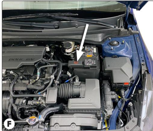
6. Du côté conducteur, repérer le fil d'alimentation **noir** de calibre 12 provenant du boîtier du connecteur en T. Connecter le fil noir de calibre 12 fourni. Acheminer le fil **noir** le long du cadre de châssis extérieur, ou suivre le filage existant le long des seuils usque la batterie dans le haut du compartiment moteur, en prenant soin d'éviter les endroits susceptibles de pincer ou endommager le fil.
