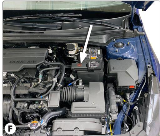
6. En el costado del conductor, localice el alambre eléctrico **negro** de calibre 12. Dé energía a través de la caja del conector en T. Instale el alambre negro de calibre 12 que se suministra. Dirija el cable **negro** a lo largo del marco exterior o siga el cable existente a lo largo de los umbrales hacia el compartimiento del motor hasta la batería evitando las áreas que podrían pellizcar o romper el cable.
