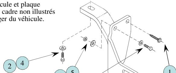
Écrous à souder existants dans le cadre à deux endroits, similaires des deux côtés du véhicule.
