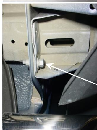
Vista lateral desde abajo del vehículo que muestra el remache de plástico retirado del soporte de apoyo del parachoques. Esto permite halar la tapa del parachoques hacia atrás para mejor acceso de la mano y de la llave.
