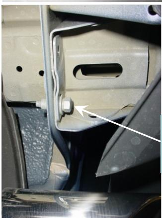
Vue latérale sous le véhicule montrant le retrait d'un rivet-poussoir en plastique du support de pare-chocs. Cela permet de dégager l'enveloppe de pare-chocs pour obtenir un meilleur accès.
