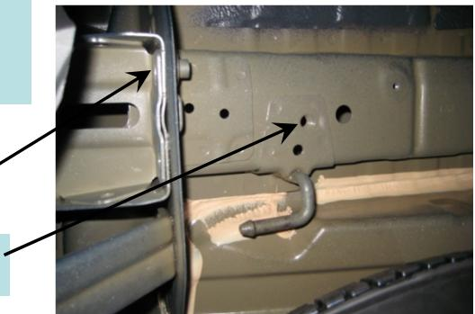
Serrer les boulons 8mm-1.25 Gr. 9.8 au couple de 25 lb-pi (34 N\*M). Serrer les boulons 10mm-1.25 Gr. 8.8 au couple de 42 lb-pi (57 N\*M).
